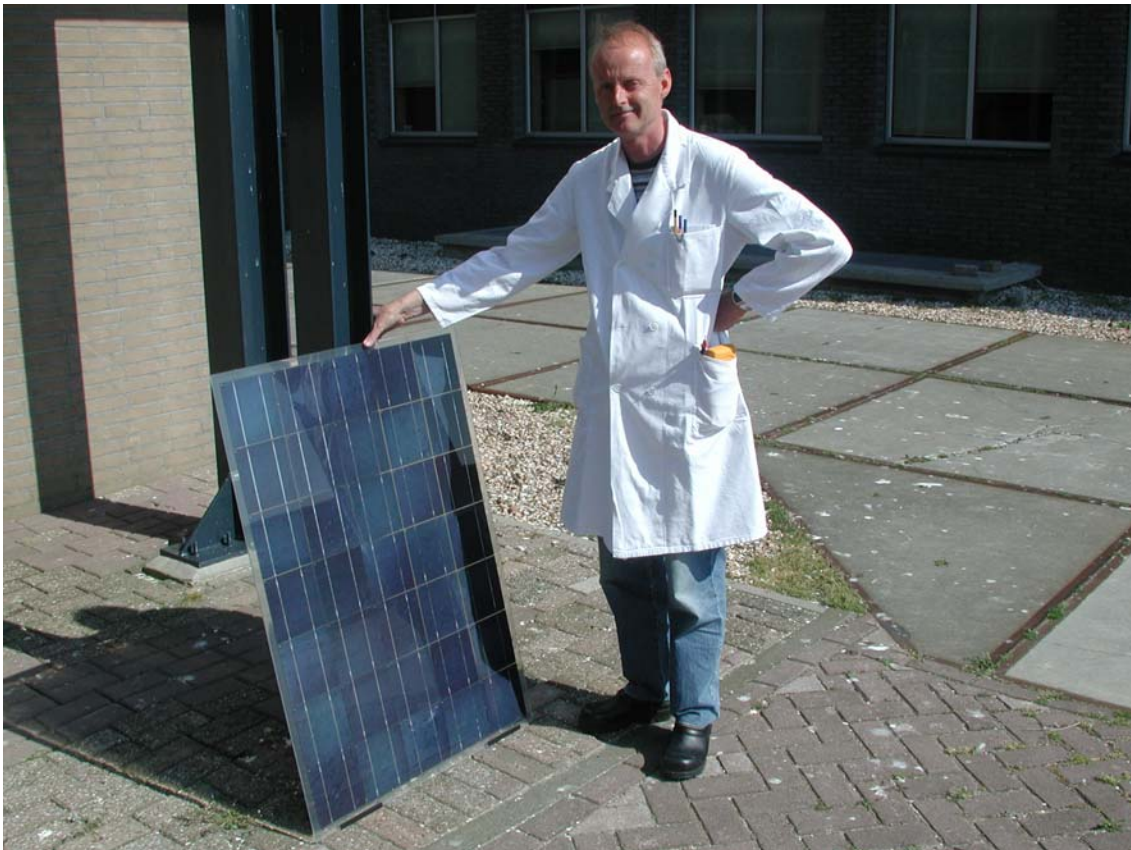
Figuur 3.1: PV-wirefree laminaat met geïntegreerde visuele indicator - de PV-watchdog – gereed voor de 19th EPSEC dankzij snelle actie van Mark Jansen en Andries Tip (ECN).
